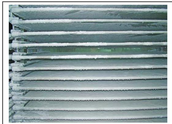
Una vez colocado el producto en el molde es introducido en el armario quedando comprimido entre las placas congelantes. El proceso de congelación dura unas 3 a 4 horas, luego se retira el producto del armario, se extrae del molde, se empaca y se almacena.
