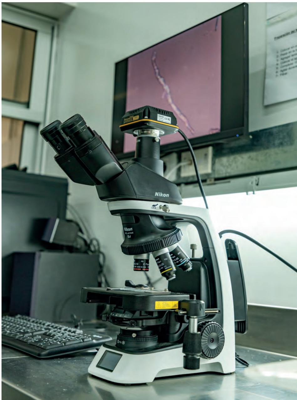
Microscopio con equipo de fotografía incorporado
