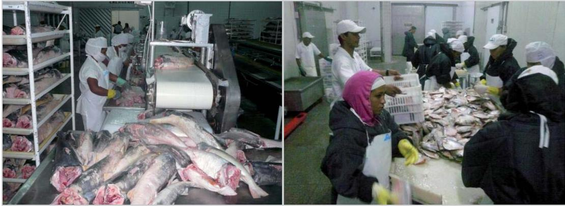
Figura 21. Linha de beneficiamento de pescado de um Entrepósito com registro no S.I.F., com capacidade produtiva para até 45 toneladas/dia.
