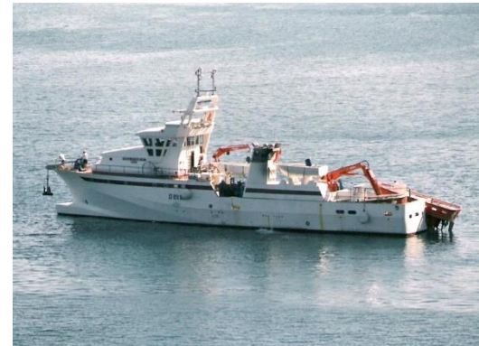
Atuneiro de cerco Ville d'Agde IV – aço/alumínio 40 m de comprimento, 8,30 m de boca, Velocidade de 17 nós
