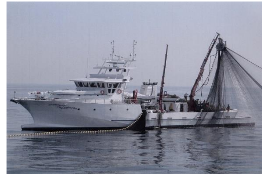
Atuneiro de cerco Geneviève – aço/alumínio 42 m de comprimento, 9 m de boca Velocidade de 17 nós
