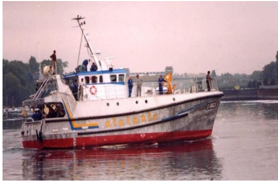
Arrasteiro de popa Atalante – alumínio 20,40 m de comprimento, 6,90 m de boca Velocidade de 12 nós
