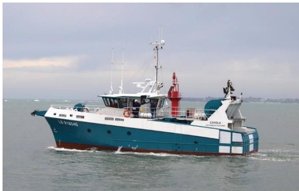
Arrasteiro de popa Cayola – aço/alumínio 21,90 m de comprimento, 7,30m de boca, Velocidade de 10,5 nós
